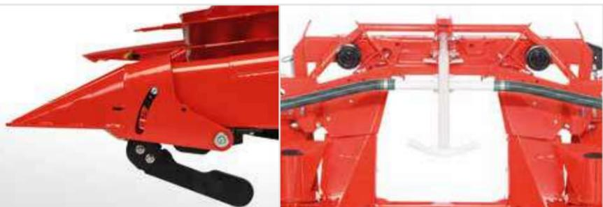
El palpador integrado en el extremo se puede mover en altura y lateralmente. Las irregularidades del terreno o las piedras provocan movimientos y generan impulsos.
