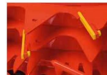
Los rascadores atornillables y fácilmente sustituibles garantizan el funcionamiento óptimo del rotor, muy fácil de mantener.
