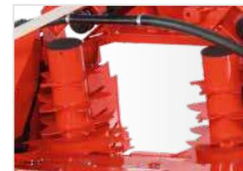
El 460<sup>plus</sup> cuenta con un canal de transmisión especialmente ancho que conecta con la picadora. Los tambores inclinados agrupan de manera limpia grandes cantidades de material cosechado y lo transportan a la picadora.
