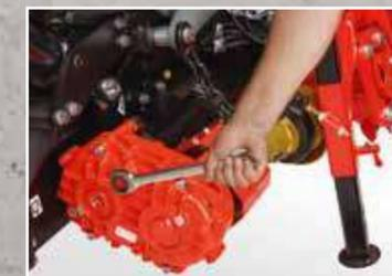
La caja de cambios de varias velocidades ofrece más velocidad en el cabezal para las diferentes longitudes de corte. Las 4 marchas permiten un flujo de la cosecha sin problemas. El dispositivo de cambio rápido integrado facilita el rápido montaje y desmontaje de los rotores.
