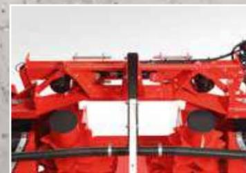
El bastidor oscilante, incluyendo el mecanismo de bloqueo automático para el transporte por carretera, está incluido de serie.
