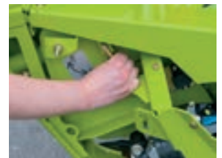
Empestillamiento sin herramientas de los divisores de mies y de las cuchillas de colza con cierre rápido
