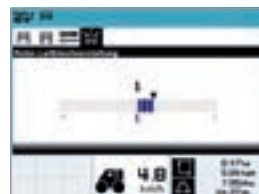
Reglaje de la chapa guía del rotor en CEBIS
