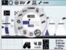
Ajuste del régimen de revoluciones del rotor en CEBIS
