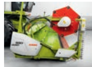
Mesa del mecanismo de corte sacada - con cuchilla de colza (+ 600 mm)
