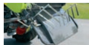
Formador de hileras en el distribuidor de chapas esparcidoras
