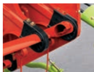
Soportes y cojinetes de las púas del molinete de plástico, con forma optimizada, para el menor transporte de tallos
