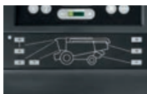
Con la celda de mando tiene lugar un control ordenado y sencillo de la iluminación de trabajo. Las configuraciones de las luces se pueden realizar rápidamente en CEBIS.
