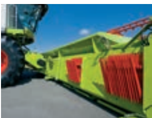
Levantadores de mies supletorios directamente detrás en el mecanismo de corte
