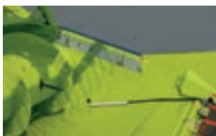
El indicador de la posición de la mesa del mecanismo de corte se ve perfectamente desde la cabina
