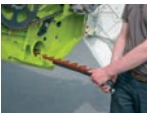
Barra de cuchillas supletorias integrada en la parte inferior del mecanismo de corte
