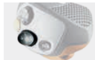
Activación del reglaje de la altura de corte (AUTO CONTOUR), reglaje de la presión de apoyo y preselección de la altura de corte, así como subir / bajar el cabezal, directamente en el mando multifuncional CMOTION
