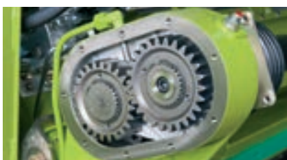
Cambio de piñón para la adaptación del régimen de revoluciones
