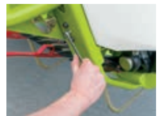
Sencillo reglaje de la altura del divisor de mies con la llave de las tapas
