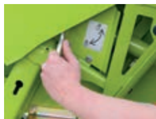
Empestillamiento sin herramientas de los divisores de mies con cierre rápido
