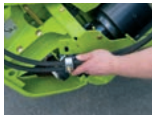
Fácil enganche de los latiguillos hidráulicos para el accionamiento de las cuchillas de colza
