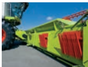
Levantadores de mies supletorios directamente detrás en el mecanismo de corte.
