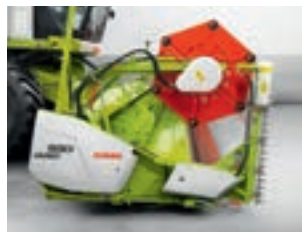
Mesa del mecanismo de corte metida - con cuchillas de colza (+ 450 mm)
