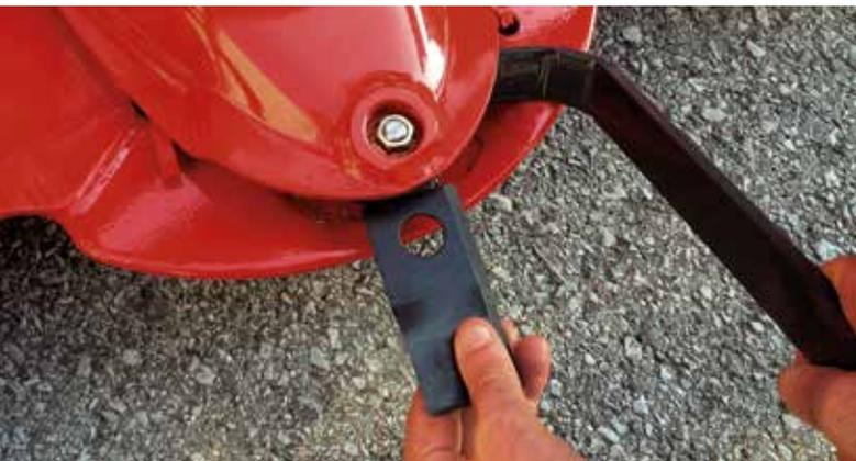
Las cuchillas son de acoplamiento rápido para reducir drásticamente el tiempo de reemplazo sin la ayuda de llaves. Los discos segadores están hechos para tener un gran solapamiento de las cuchillas y permitir un corte perfecto incluso en el producto más espeso y húmedo.
