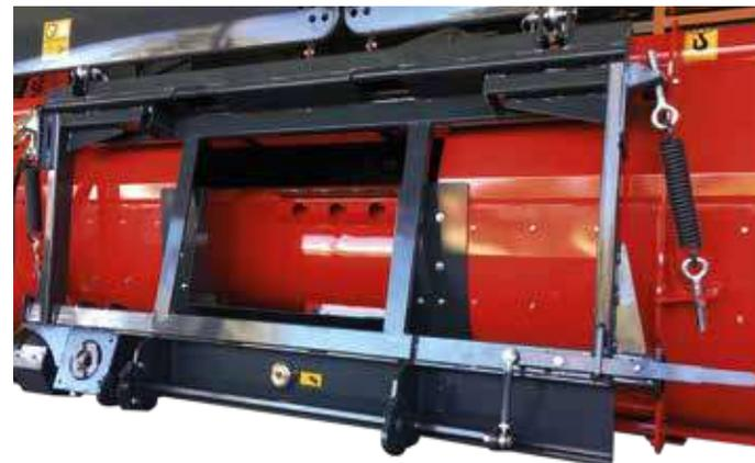
El empujador delantero del producto se modifica desde el vehículo y permite adaptarse a las irregularidades. SPARTAN es adaptable a todos los tipos y modelos de auto-propulsados de cosechadora de forraje por la sencilla sustitución del rit adaptador.
