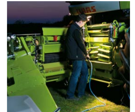
QUICK ACCESS hace que la inspección de los órganos picadores sea posible en pocos minutos.
