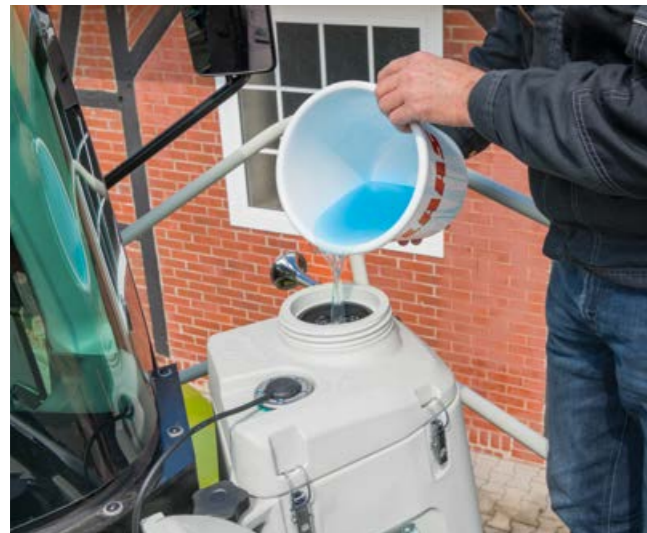
Relleno del depósito de aditivos de ensilado
