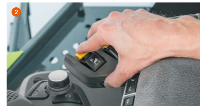
Invertir a través de CMOTION (1) o presionando al mismo tiempo el interruptor y la tecla de inversión (2)
