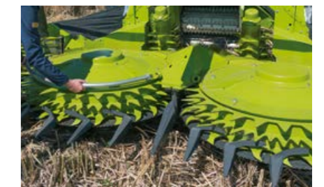
Desmontaje de las trampas para mazorcas incrementa la capacidad de flujo.
