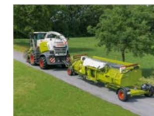
Remolque de transporte con DIRECT DISC encima.
