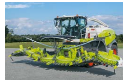
Protección automática de transporte.
