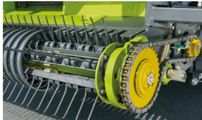
Robusto recogedor para una limpia recogida del forraje.
