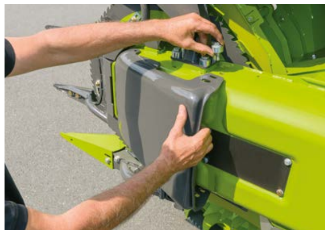
Patines con ajuste de la altura en dos niveles.
