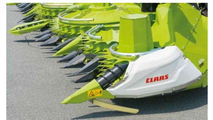
En caso necesario, el accionamiento de los sinfines de maíz tumbado tiene lugar de forma hidráulica.
