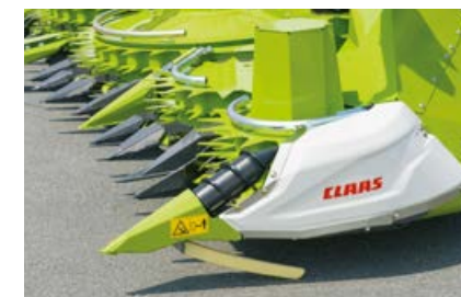
Punta de maíz tumbado accionada hidráulicamente.
