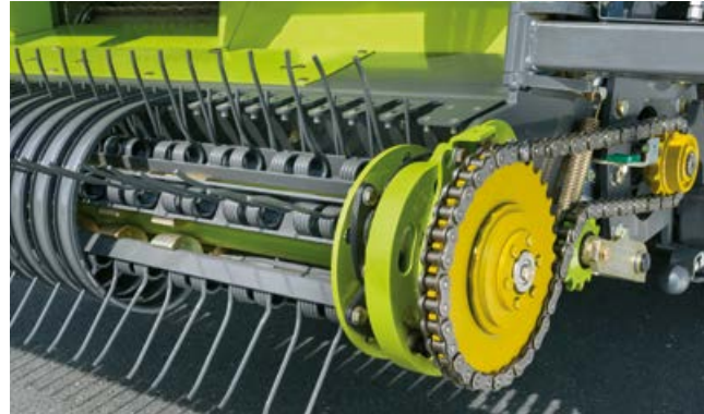
Robusto recogedor para una limpia recogida del forraje.
