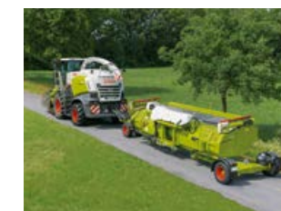
Remolque de transporte con DIRECT DISC encima.
