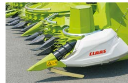
Punta de maíz tumbado accionada hidráulicamente.
