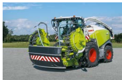
Rápido proceso de pliegue de posición de transporte a posición de trabajo y viceversa.
