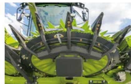
Robustos dedos de alimentación y deflectores debajo del disco de cuchillas para un limpio modo de trabajo.
