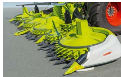
Construcción muy plana para rastrojos bajos.
