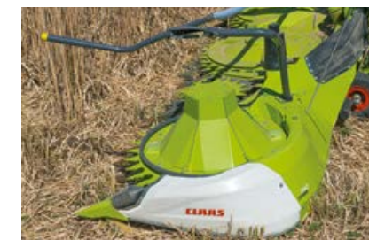
El gran cono de maíz tumbado optimiza el flujo y evita que material de cosecha se quede en el disco de transporte.
