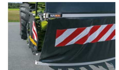
La protección delantera y las laterales se ven perfectamente con los adhesivos de advertencia. La iluminación LED está totalmente integrada
