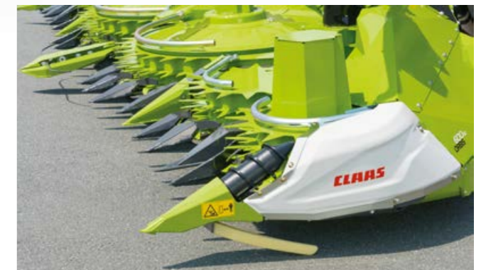
En caso necesario, el accionamiento de los sinfines de maíz tumbado tiene lugar de forma hidráulica.
