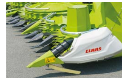
Punta de maíz tumbado accionada hidráulicamente.
