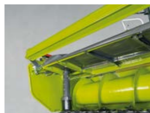
Repartidor de rodillos para una alimentación muy homogénea del material de cosecha.
