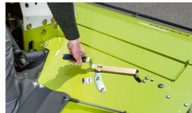
Reglaje de los discos hileradores con una manipulación.
