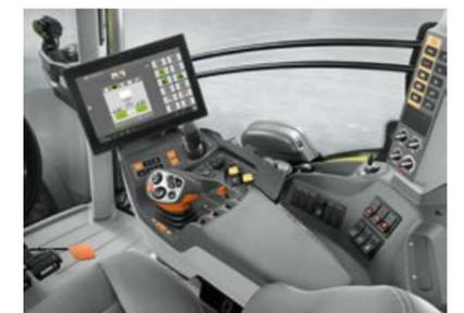
Cuando el tractor está equipado con un terminal compatible con ISOBUS, el manejo preseleccionado para el CONTOUR puede ejecutarse directamente a través de éste.
