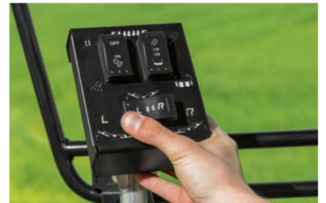
Para DISCO 1100 TREND se ofrece una práctica unidad de mando para la elevación individual, el plegue a la posición de transporte y, opcionalmente, para encender y apagar los focos de trabajo.
