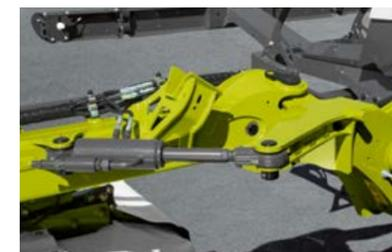
Protección en el caso de choque mediante el seguro antichoque hidráulico Non-Stop: La unidad segadora sale y se coloca por sí misma en la posición de salida.
