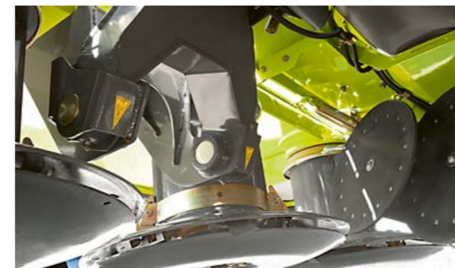
El punto de giro cercano al suelo ofrece una óptima adaptación longitudinal de la segadora.
