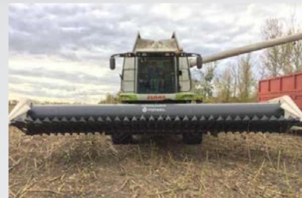
Este modelo se ha equipado con una pantalla cubriendo el molinete y un rulo dentado bajo las bandejas que **mejora la alimentación de las plantas**. El escudo es regulable para adaptarse a las condiciones de la cosecha, y ayuda a las flores a alcanzar las cuchillas en una óptima posición, que permite cortar únicamente la cabeza de la flor, dejando el tallo en el suelo.
