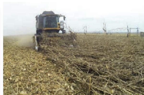
**Cadena alimentadora superior:** Con éste elemento (opcional) se consigue que la recolección del maíz en condiciones extremas, cuando las matas se encuentran tumbadas en el terreno, se puedan recolectar con mucha facilidad, consiguiendo una alimentación continua al cabezal y un alto rendimiento de la cosechadora con unas mínimas pérdidas de grano.
