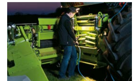
QUICK ACCESS hace que la inspección de los órganos picadores sea posible en pocos minutos.
