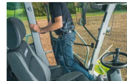
El interruptor del asiento desconecta automáticamente el cabezal y la transmisión principal.
