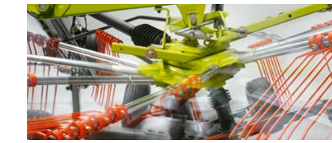
Enganche cardánico de los rotors: Los rotors se adaptan al suelo – independientemente del tractor.
