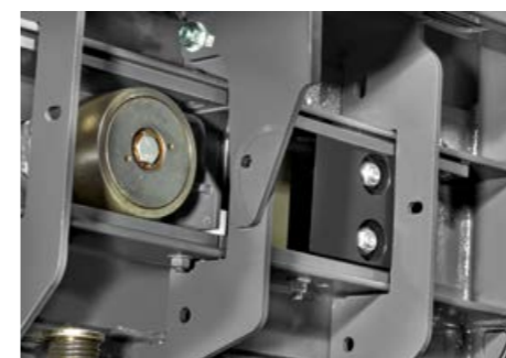
Las cuchillas giratorias pueden ser montadas en dos posiciones para el trabajo en paja / paja de maíz o en heno / ensilado
