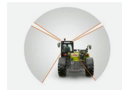
Vista hacia atrás sin limitaciones con el brazo telescópico con articulación baja – para una mayor seguridad de trabajo.
