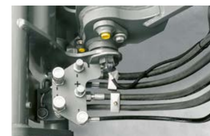
Conexiones hidráulicas colocadas protegidas en el portaherramientas.
