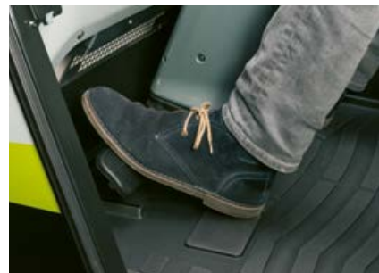
El pedal de freno con función de marcha lenta reduce el consumo de combustible y el desgaste de los frenos.
