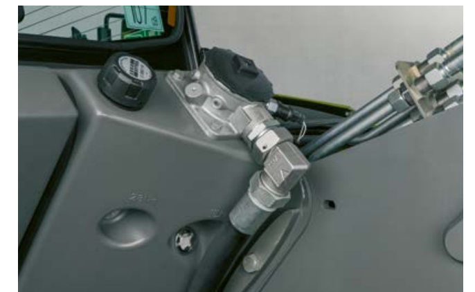
El nivel de aceite hidráulico se puede controlar cómodamente mediante un cristal de observación. La instalación hidráulica está protegida mediante un filtro de retorno. El filtro solo lo cambia pasadas 1.000 horas de servicio.
