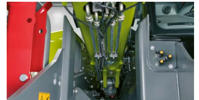
Guiado lateral del brazo telescópico integrado en el marco, de serie, en todas las cargadoras con una capacidad de carga superior a 4.500 kg.
