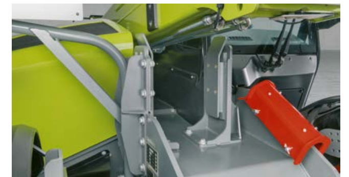
Guiado lateral del brazo telescópico disponible para todos los modelos SCORPION.
