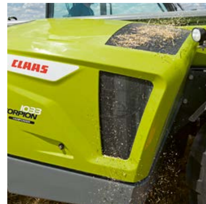
Se evita que el radiador se ensucie con ventilador reversible.
