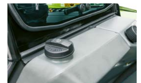
El depósito de combustible detrás de la cabina puede ser cerrado con llave.
