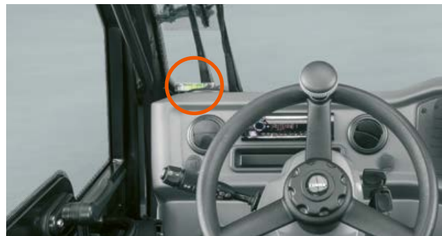
Nivelador de burbuja en la cabina.
