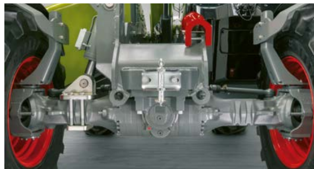
Mecanismo de traslación con compensación hidráulica del nivel.
