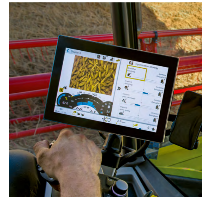
Control inteligente con CEMOS AUTOMATIC vía CEBIS.
